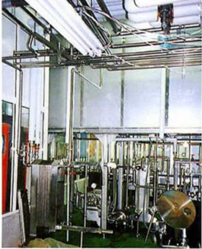
殺菌用キャビネット（架台上） 正面、架台下のプレートが加熱用
